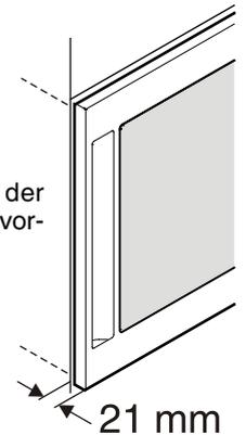
5. Anschließend das Gerät mit Spanplattenschrauben 3,5 x 17 durch den oberen Winkel befestigen.
