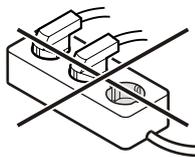
Keine Inselwechselrichter (Umwandeln von Gleichstrom in Wechsel- bzw. Drehstrom) oder Energiesparstecker verwenden. Beschädigungsgefahr für die Elektronik!
