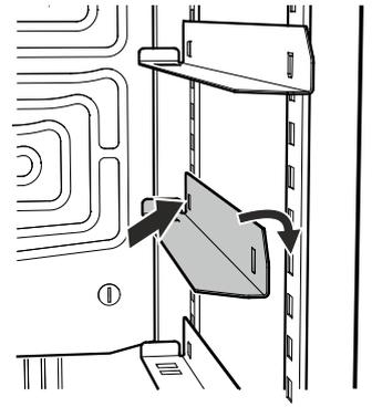
Schienen in gewünschter Höhe zuerst in hinterer Rastenleiste einschieben und dann vorne einhängen.
