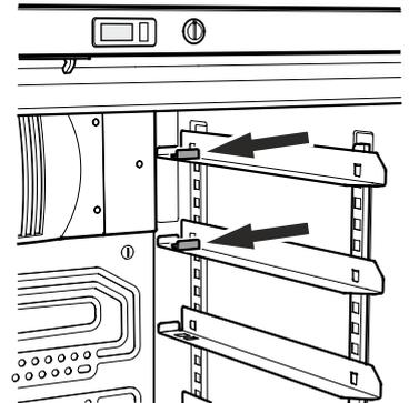
Dadurch wird verhindert, dass das Backblech an der Ventilatorabdeckung anschlägt.
