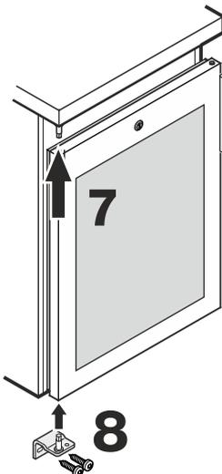
8. Scharnierwinkel in unteres Türlager einsetzen und anschrauben.
