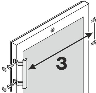
4. Bolzen im Scharnierwinkel umsetzen.
