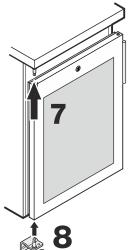
**8.** Scharnierwinkelinunteres Türlager einsetzen und anschrauben.
