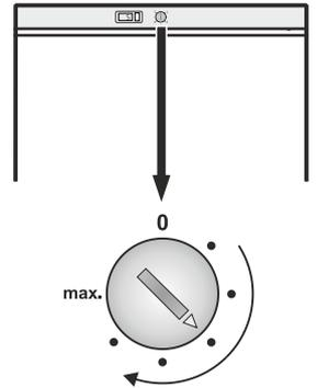
Je näher der Regler in Richtung **max.** gedreht wird, desto kälter wird es im Innenraum.
