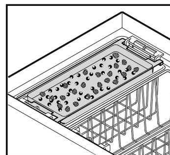
Das Gefriertablett kann entweder in den Korb eingelegt oder als Trennwand in den Innenbehälter eingeschoben werden.
