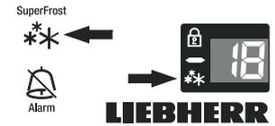
**Achtung:** Bei Betätigen der SuperFrost-Taste kann es durch die eingebaute Einschaltverzögerung zu einem bis zu 8 Minuten verspäteten Einschalten des Kompressors kommen. Diese Verzögerung erhöht die Lebensdauer der Kältemaschine.
