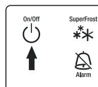
**Ausschalten:** ON/OFF-Taste ca. 3 Sekunden lang drücken, so dass die Temperaturanzeige dunkel ist.
