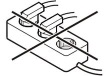
Keine Inselwechselrichter (Umwandeln von Gleichstrom in Wechsel- bzw. Drehstrom) oder Energiesparstecker verwenden. Beschädigungsgefahr für die Elektronik!
