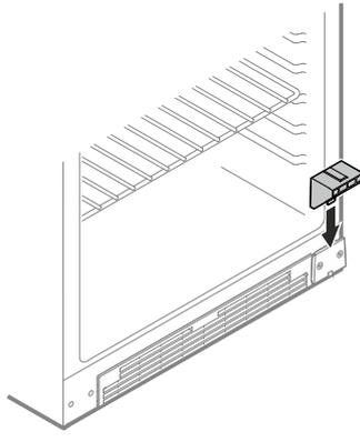
**12. Transportsicherung aufsetzen.**
