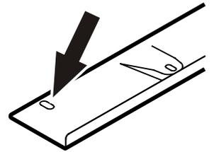
Abdeckleiste einsetzen (bei Bedarf kürzen).
