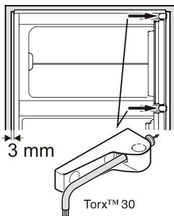
Mit den unteren Gewindebuchsen das Gerät in der Höhe justieren.
