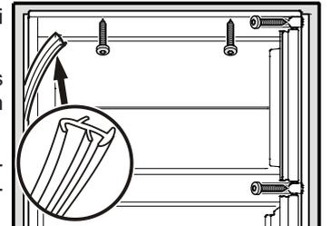
Das Gerät unten mit Schrauben 4 x 36 durch die Gewindebuchsen befestigen.
