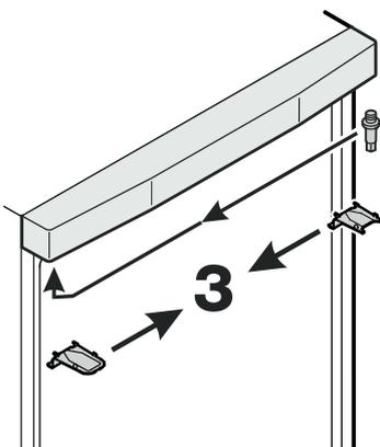
4. Unteren Scharnierwinkel und Abdeckplatte umsetzen.
