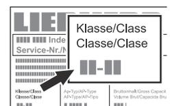
Die Klimaklasse ist auf dem Typenschild aufgedruckt.
