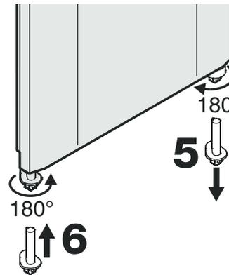
5. Unteren Türlagerbolzen 180° drehen und herausziehen.
