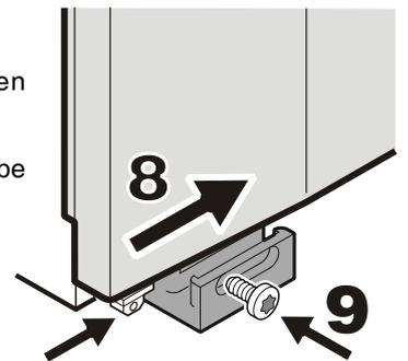
4. Unteren Scharnierwinkel und Abdeckplatte umsetzen.
