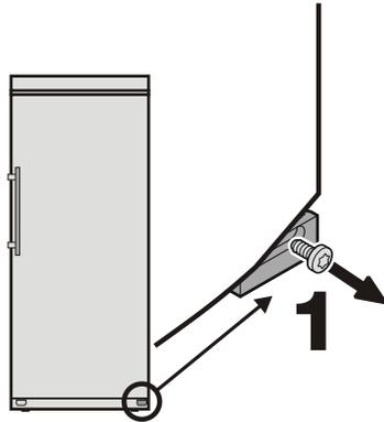
5. Unteren Türlagerbolzen 180° drehen und herausziehen.
