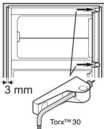
Das Gerät unten mit Schrauben 4 x 36 durch die Gewindebuchsen befestigen.
