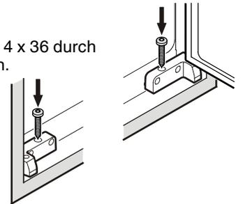
Mit den unteren Gewindebuchsen das Gerät in der Höhe justieren.
