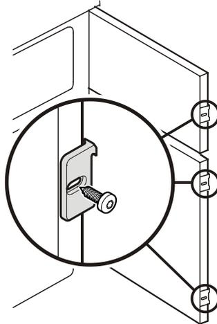
Abdeckleiste einsetzen (bei Bedarf kürzen).
