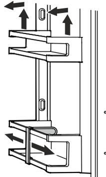
Platz für hohe Gefäße ermöglichen die **halben Glasplatten**. Beiliegende Auflageschienen, Abb. 1, in gewünschter Höhe rechts und links auf die Auflagenoppen aufstecken.
