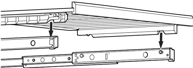
Auszugschienen ganz herausziehen. Das Holzbord mit den vorderen Ausnehmungen auf die Haltebolzen aufsetzen.
