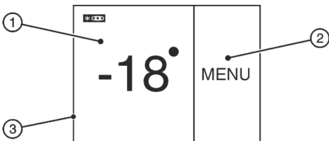
Fig. 3 (1) Gefrierteil-Feld (2) Menü-Feld (3) Bildschirm
